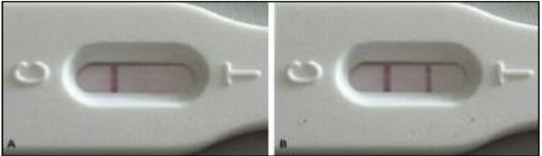
Figura 1. Visualización de las líneas testigo y muestra en el Aspergillus -LFD. (A) resultado negativo, (B) resultado positivo.
